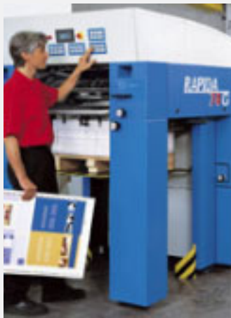
Wasserloser Offset ohne Farbzonenschrauben: Die neue Rapida 74 Gravuflow™ belegte beim Innovationspreis der deutschen Druckindustrie den ersten Platz unter den Druckmaschinen
