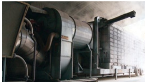
RAUCHGASFREIE TROCKNUNGSANLAGEN SORGEN FÜR QUALITÄT UND WERDEN MIT UMWELTFREUNDLICHER ENERGIE AUS UNSEREN BIOGASANLAGEN BETRIEBEN.
