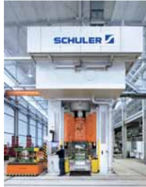
Hydraulische Ziehpresse zur Herstellung von Heizkesselteilen
