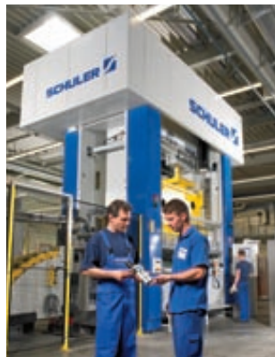
Stanz- und Umformautomat mit Servoantrieb (400 t Presskraft)
