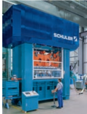
Stanz- und Umformautomaten mit Kniehebelantrieb sind ab sofort mit vergrößertem Stößelhub lieferbar
