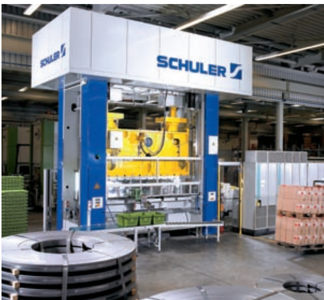
Stanz- und Umformautomat mit Servoantrieb automatisiert, mit Bandanlage und Vorschub. Maximale Presskraft: 400 t
