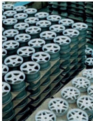
Aluminiumräder hergestellt auf einer unserer hydraulischen Schmiedelinien
