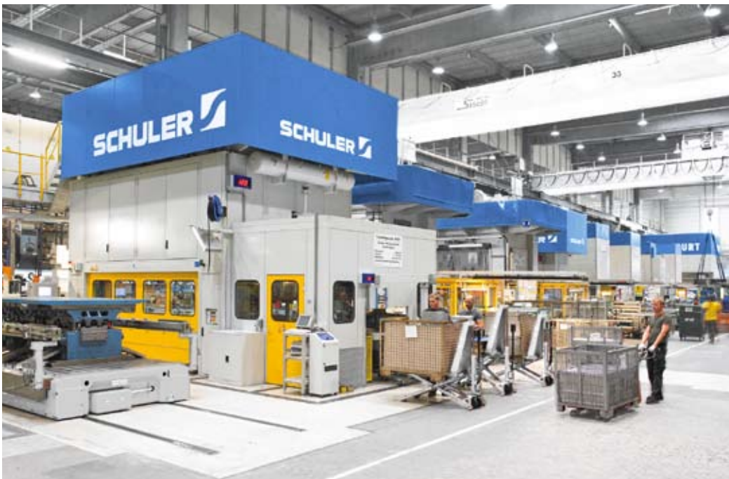
Herde und Kochfelder werden auf der 800-t-Plattformpressenanlage gefertigt (siehe Seite 15)
