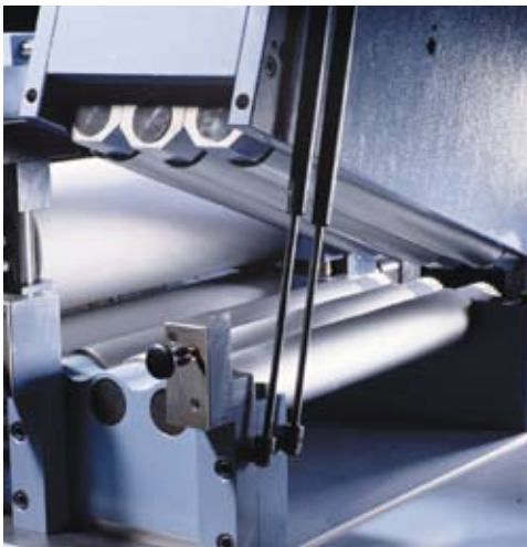
Die Richtmaschine einer Bandzuführanlage von Schuler, die in verschiedenen Branchen zum Einsatz kommt
