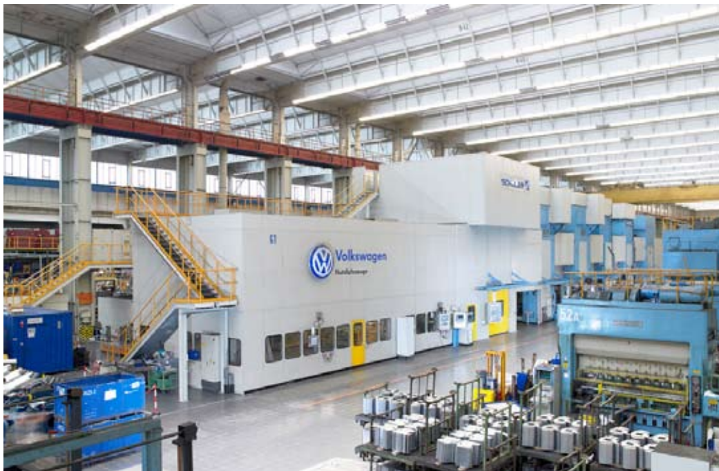
Hochwertig, flexibel, schnell – Hydraulische Pressenlinie fertigt nahezu alle Außenhautteile des neuen Porsche Panamera
