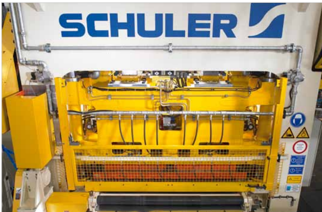
Schuler-Napfpresse für die Verpackungsindustrie: Der geschweißte Monoblockkörper mit spielfrei vorgespannter Stößelführung ermöglicht eine präzise Stößelbewegung
