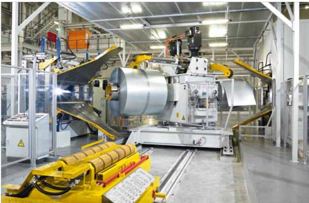
Neue Schuler-Schnittlinie mit ServoDirekt-Technologie zur Optimierung der Coilvorbereitung bei BMW
