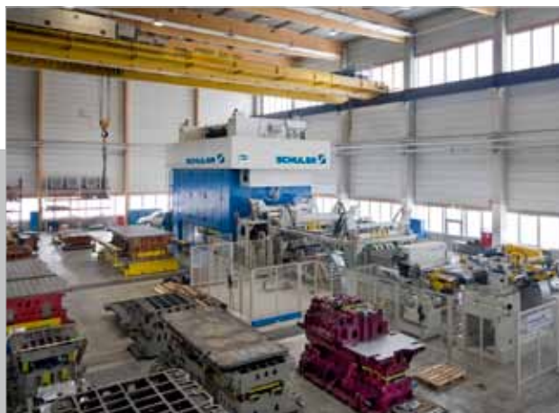
Servopresse in Zugankerbauweise mit Bandanlage und Platinenlader von Schuler
