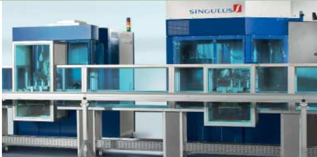
SINGULUS TECHNOLOGIES hat sich entschlossen, eine eigene voll in die Fertigung von Silizium-Solarzellen integrierte Beschichtungsanlage für das Aufbringen von Antireflexionsschichten zu entwickeln. Durch eine besonders hohe Qualität der Schicht sollen die Antireflexions- und Passivierungseigenschaften verbessert und damit die Energieausbeute der fertigen Zellen erhöht werden. Die erste SINGULUS TECHNOLOGIES Beschichtungsanlage soll noch in 2008 geliefert werden.
