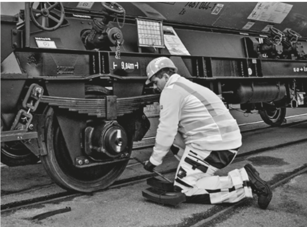
Austausch von Bremssohlen bei einer mobilen Instandhaltung
